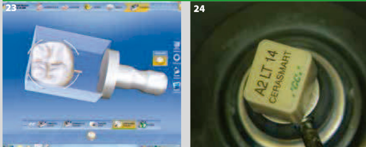
Fig. 23 y 24 Configuración de la posición de fresado y del inicio del mismo.
