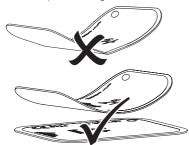
No arañe las placas radiográficas. No aplique presión a las placas radiográficas con objetos duros o puntiagudos.
