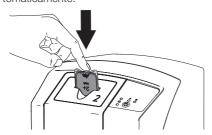
La funda protectora de la luz permanece en la ranura de entrada, y no entra en el aparato. Se ilumina la indicación amarilla de estado. Los datos de imagen se han transferido automáticamente al software Imaging. El avance del proceso de lectura se representa en la ventana de previsualización del monitor.
